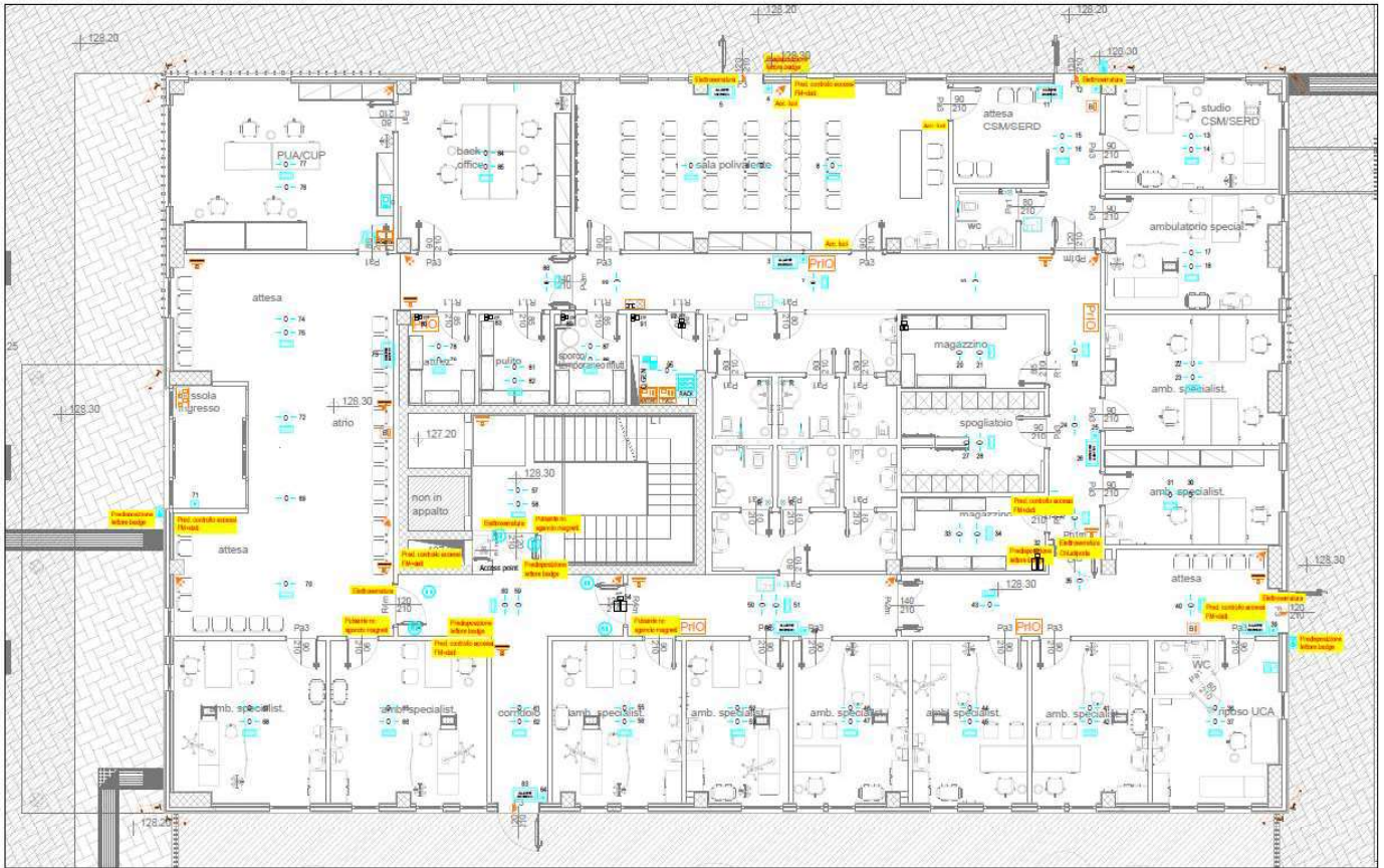
DISTRIBUZIONE IMPIANTI SPECIALI LAYOUT: PIANO TERRA - SCALA 1:100
